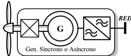
Fig. 3-14: Esquema de un aerogenerador de velocidad variable y paso de pala fijo.
